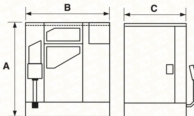
**Caratteristiche tecniche: i valori sono indicativi.** La velocità della macchina può variare in base al materiale usato e al tipo di particolare da rullare. Dimensioni in mm.
