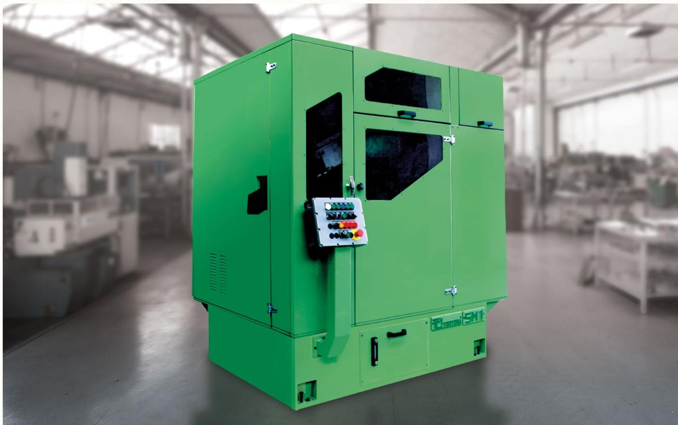
Macchine appuntatrici in grado di lavorare ad alte velocità di produzione, con un perfetto bloccaggio del particolare che ne impedisce la rotazione durante la lavorazione. È possibile inoltre fornire la macchina singola oppure abbinata alla rullatrice, montandola a monte di quest'ultima, evitando
