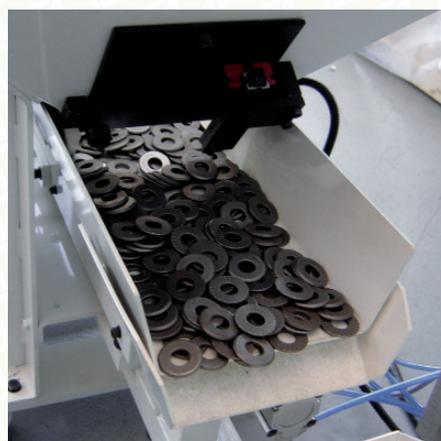
È composto da una tramoggia di carico e da una colonna di salita sulla quale è montata una paletta di carico. Quest'ultima, alimentata dalla tramoggia vibrante – una volta caricate le viti o le rondelle – sale lungo la colonna e le va a scaricare direttamente nel vibro-alimentatore della rullatrice. Questo sistema consente di ridurre gli ingombri e gli spazi di carico e di automatizzare il ciclo di lavoro.
