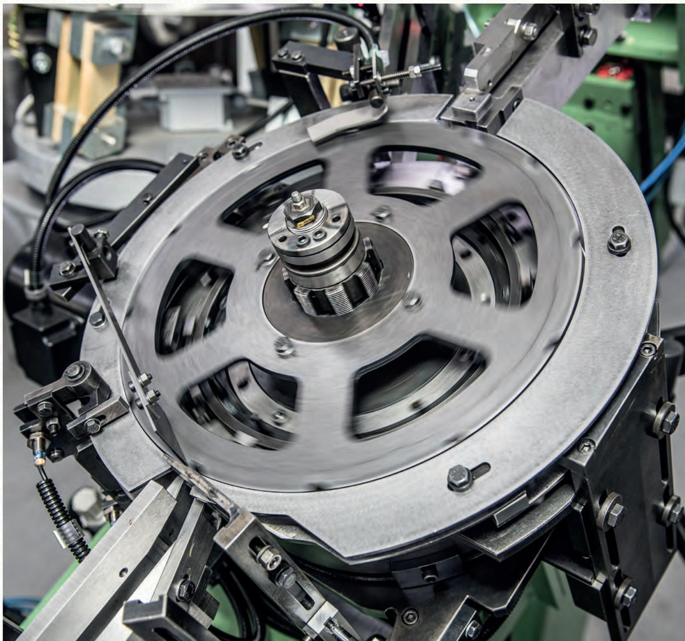
I Caricatori Boccole di TLM sono sistemi automatici di assemblaggio disegnati in base alla configurazione delle boccole e alle esigenze di produzione del cliente.
