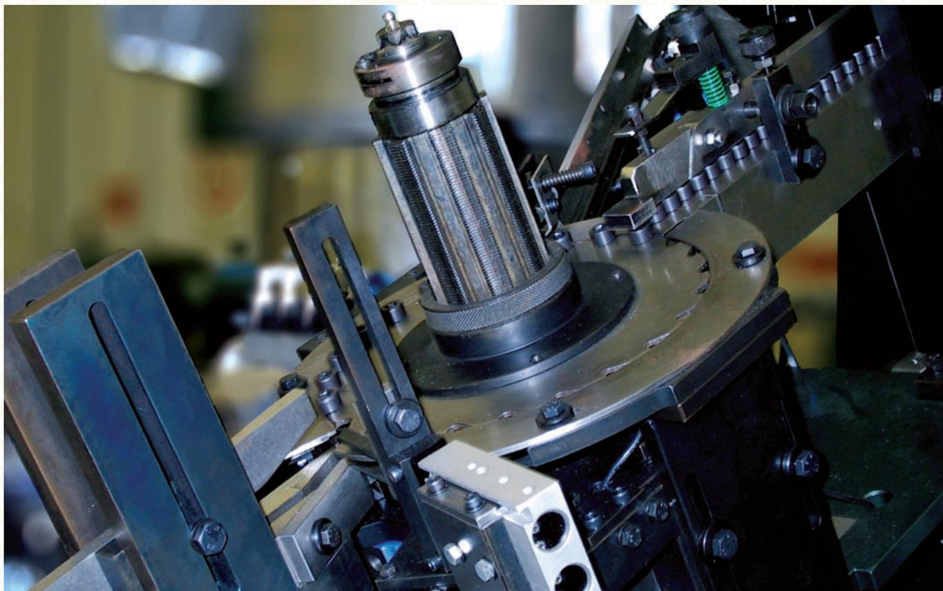
Nos chargeurs rondelles/douilles TLM sont des dispositifs automatiques d'assemblage formés de carrousels de diamètres 150/200/300 mm qui permettent de charger des micro-rondelles ou des rondelles avec un diamètre jusqu'à 60 mm. La mécanique de ces groupes est gérée électroniquement sur l'API, avec une logique qui garantit l'absence totale de rebuts durant la production.
