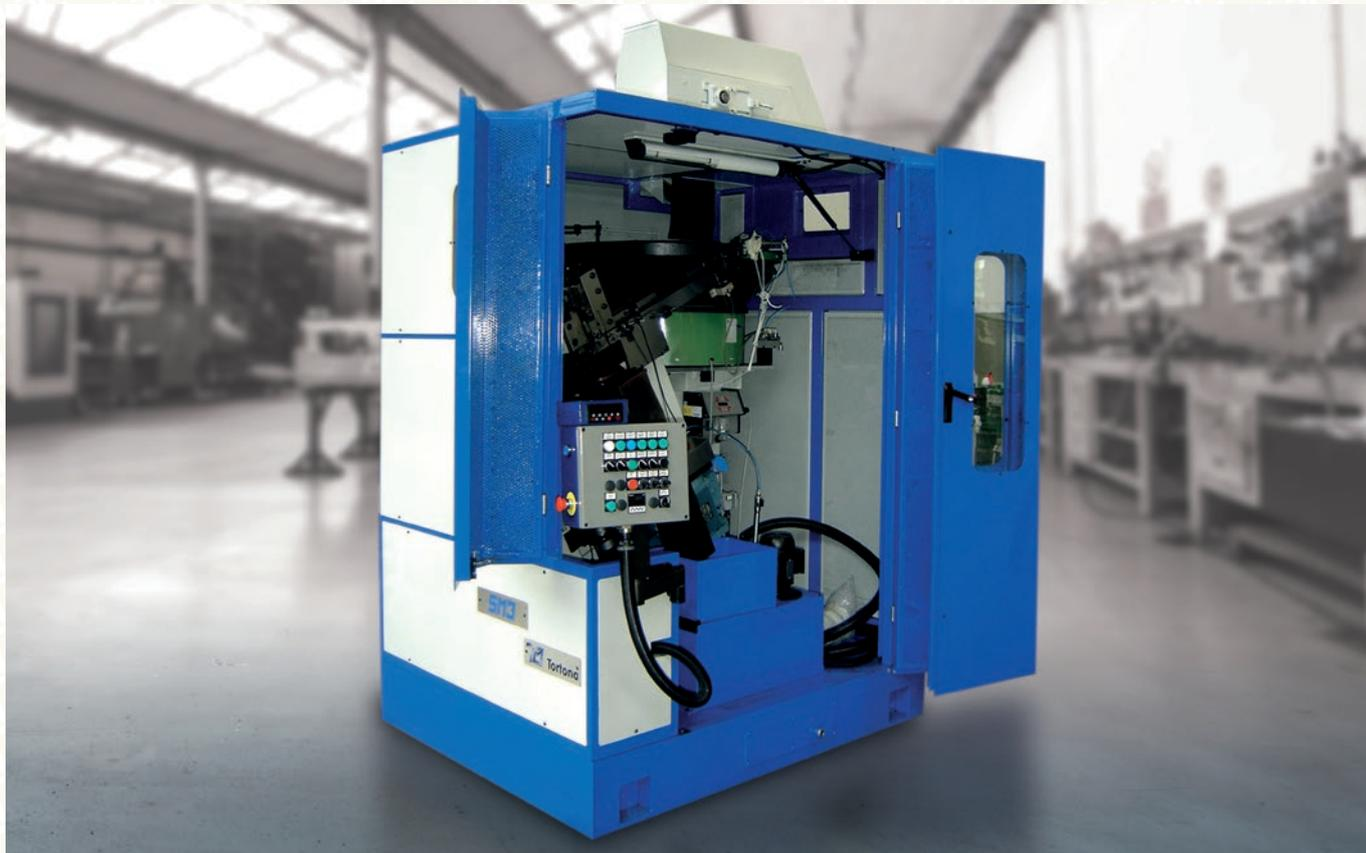
Les machines à chanfreiner peuvent travailler à vitesses de production très hautes, avec un blocage parfait de la pièce qui empêche la rotation pendant le travail. En outre la machine peut être livrée seule ou accouplée à la machine à rouler montée avant
