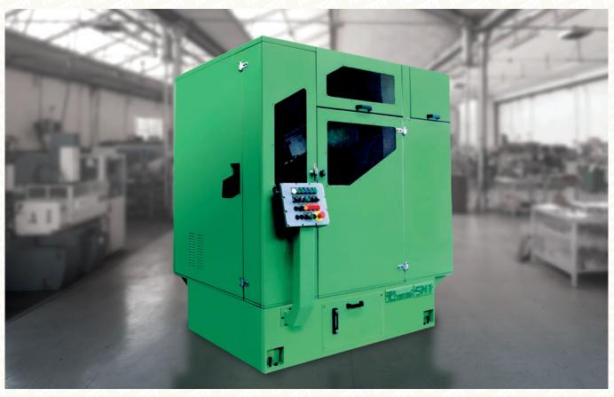
Máquinas achaflanadoras capaces de trabajar a atlas velocidades de producción con un perfcto bloqueo de la pieza que impide su rotación durante el trabajo. Es posible, además, suministrar la máquina sola o bien combinada con la fileteadora, montándola antes de ésta, evitándose de esta
