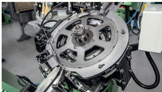
RP8LD con carro sobre patines combinado con cargador de casquillos especial. Carga y rulado de casquillos de hasta 16 mm de diámetro.
