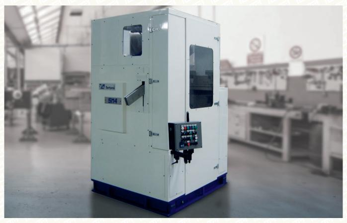
Die Abschrägmaschinen arbeiten zu hohen Geschwindigkeiten mit einer einwandfreien Befesti-gung des Werkstückes, die das Drehen während der Bearbeitung verhindert. Die Maschine kann allein oder mit der Wälzmaschine verbunden geliefert werden. In diesem Falle wird sie vor der Wälzmaschine montiert, um
