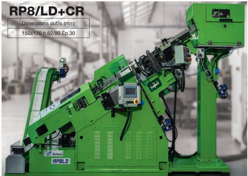
Avec coulisseau à peignes associé au chargeur de douilles spécifique. Chargement et roulage de douilles jusqu'à 16 mm de diamètre.
