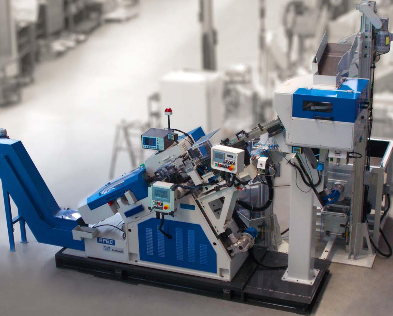
La nouvelle machine à rouler combinée RP6D avec chargeur rondelles
